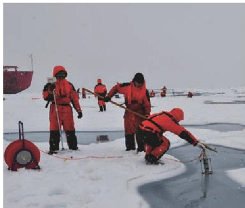
图 9-2-8 测量冰面融池的温度和盐度
